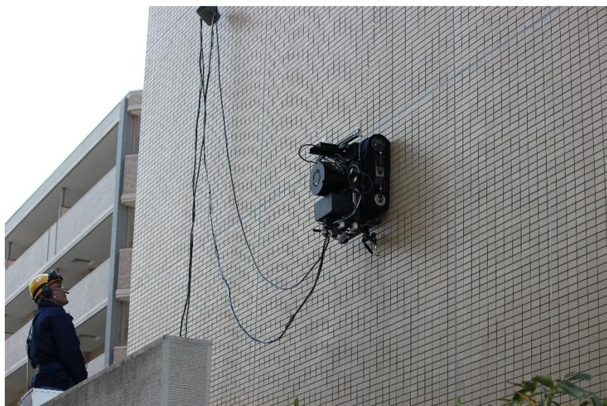
「壁面走行ロボットによる外壁点検システム」実際の建築物での外壁診断の状況（2019年2月）
