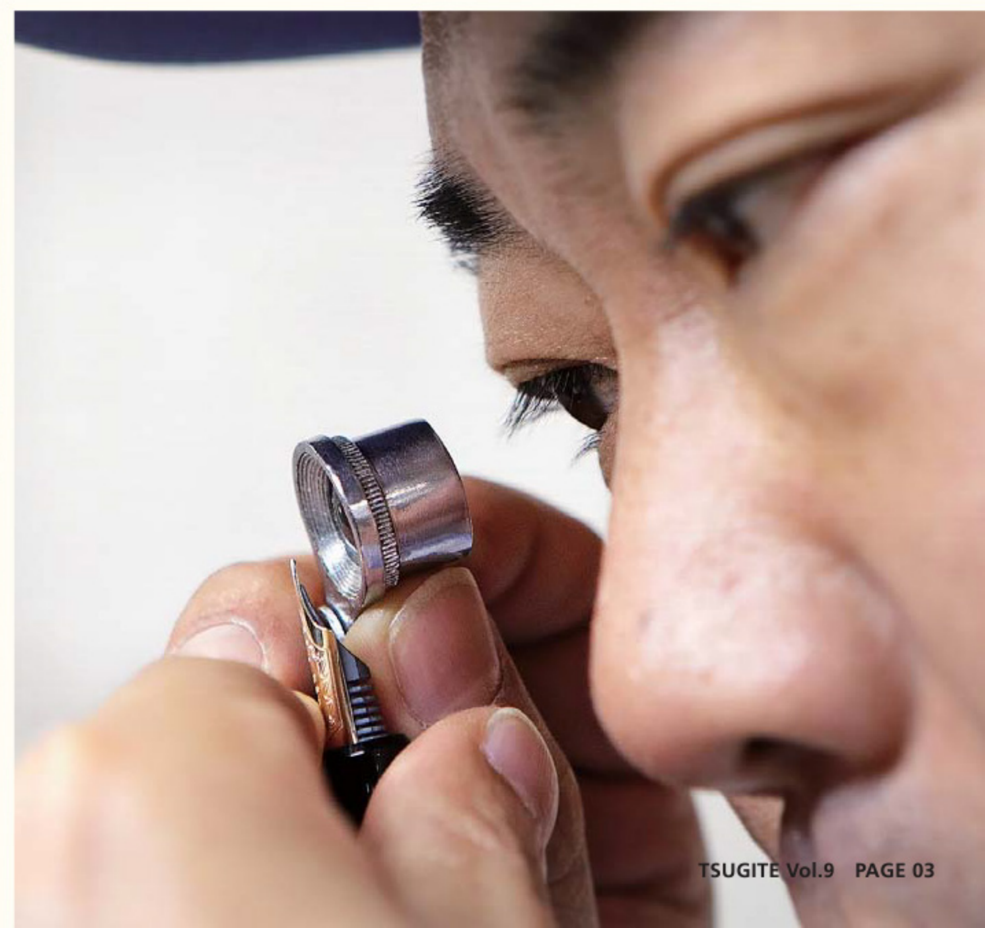
小さな球をひとつひとつ溶接しペンポイントをつくっていく
