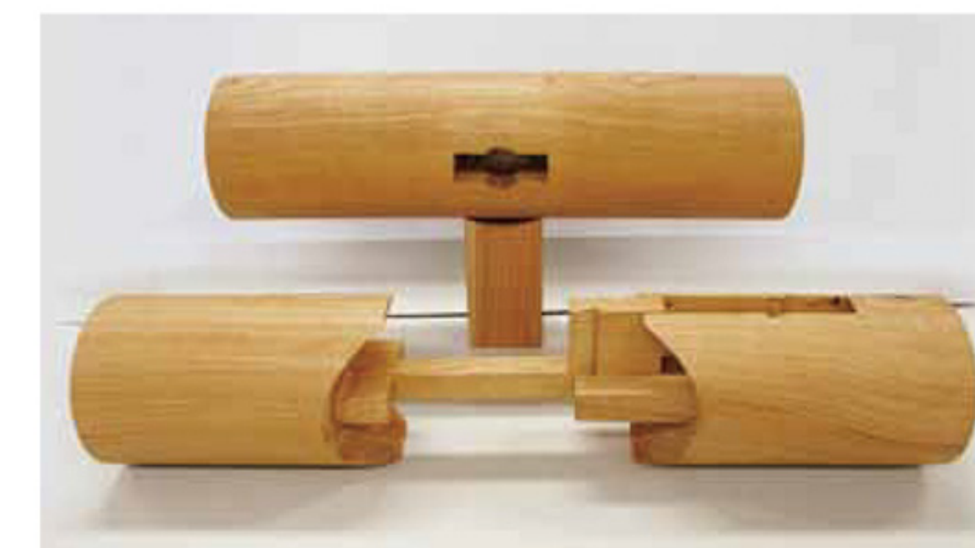
まるたのきばたつぎてしやせんつき 丸太軒継手車知榎組 組み立て前…建物の軒を支える桁の四隅で用いる継ぎ手
