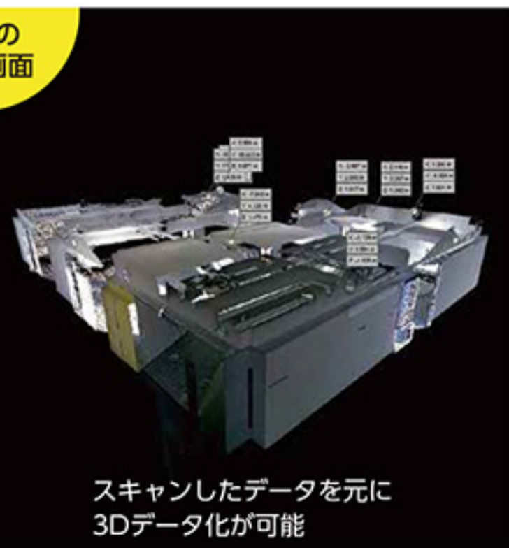
レーザーが壁や天井に当たる距離を計測
